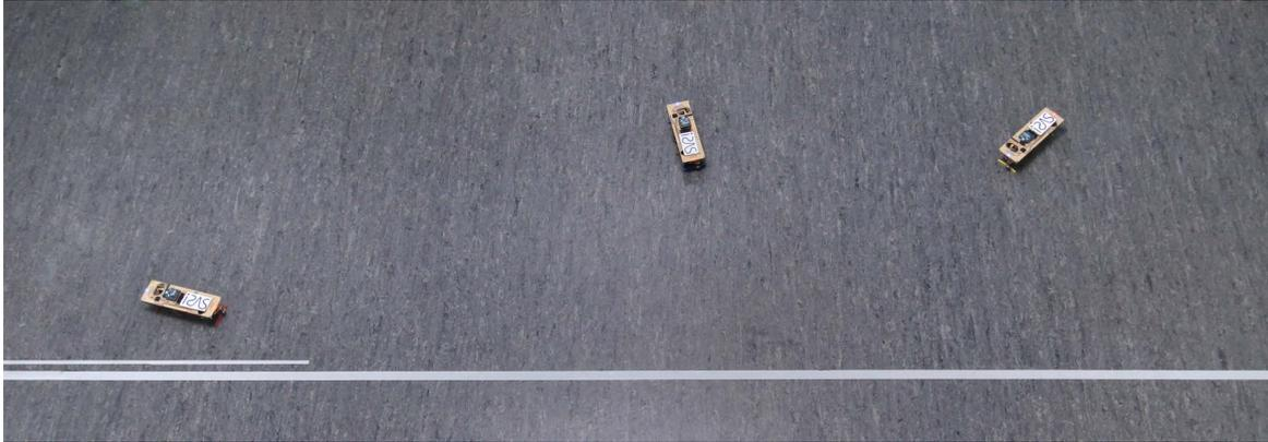
**Abbildung 7.4:** Experiment zu Beispielszenario A. Das Hindernis ist durch die Bodenmarkierung im unteren Bildteil symbolisiert, wobei der optimale Abstand durch den dünnen Strich markiert ist. Die beiden Roboter in der oberen Bildhälfte dienen als Landmarken zur Abstandsmessung.
