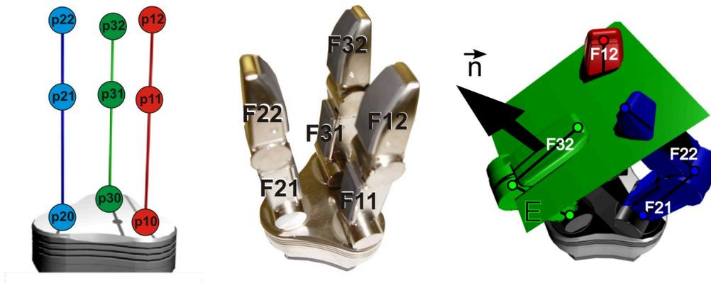
Abb. 3.18.: Modell des Mehrfignergreifers [43]
