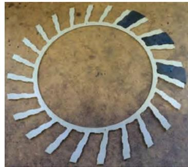
(d) PEEK plate of rotor
