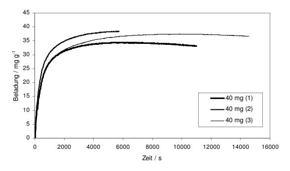
Abb. 8.2: Zeitlicher Verlauf der Beladung von monolithischem Trägermaterial mit 40 mg Pt(cod)(me)<sub>2</sub> in CO<sub>2</sub> bei 60 °C und 15 MPa.
