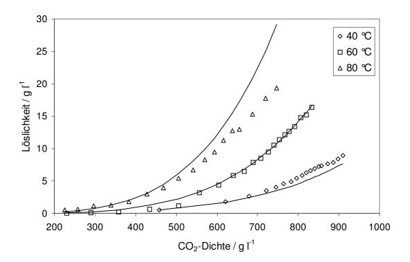
Abb. 7.15: Löslichkeit von Pt(cod)(me)<sub>2</sub> in überkritischem CO<sub>2</sub> in Abhängigkeit der Dichte; Punkte sind gemessene Werte, Linien sind mit dem Modell nach Chrastil berechnete Werte.
