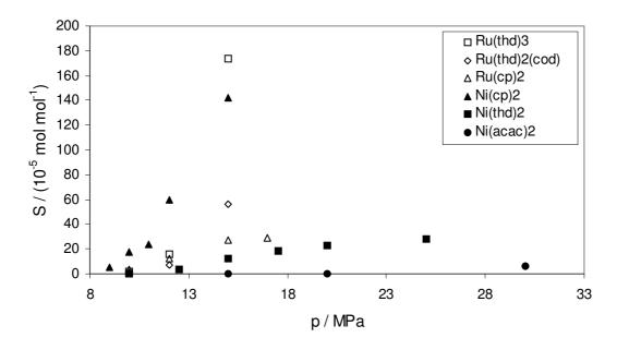
Abb. 7.3: Löslichkeit S von Ruthenium- und Nickelverbindungen in überkritischem CO<sub>2</sub> bei 60 °C.
