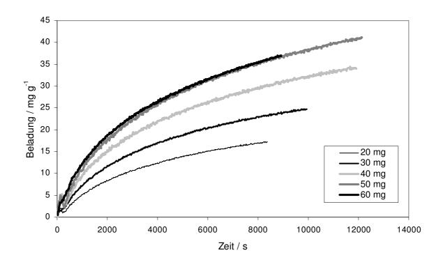
Abb. 8.6: Zeitlicher Verlauf der Beladung von Kieselgeltabletten mit Pt(cod)(me)<sub>2</sub> in CO<sub>2</sub> für verschiedene Mengen Pt(cod)(me)<sub>2</sub> bei 60 °C und 15 MPa.
