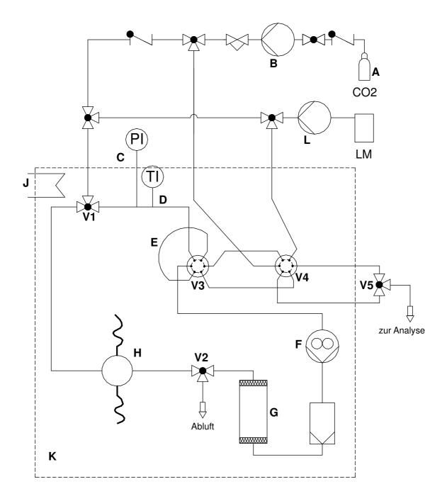
Abb. 5.3: Fließbild der Apparatur zur experimentellen Bestimmung der Löslichkeit von Feststoffen in überkritischem CO<sub>2</sub> mittels Kreislaufführung und UV/Vis-Spektroskopie.
