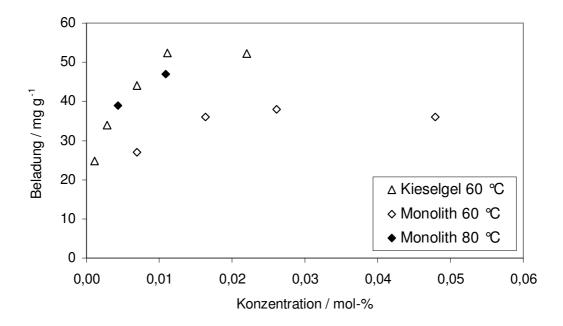
Abb. 8.11: Beladungsisothermen von monolithischem Trägermaterial und Kieselgeltabletten für die Beladung mit Pt(cod)(me)<sub>2</sub> in CO<sub>2</sub> bei 60 und 80 °C und 15 MPa.
