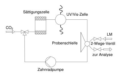
Abb. 5.2: Schematische Darstellung der Apparatur zur experimentellen Bestimmung der Löslichkeit von Feststoffen in überkritischem CO<sub>2</sub> mittels Kreislaufführung und UV/Vis-Spektroskopie.
