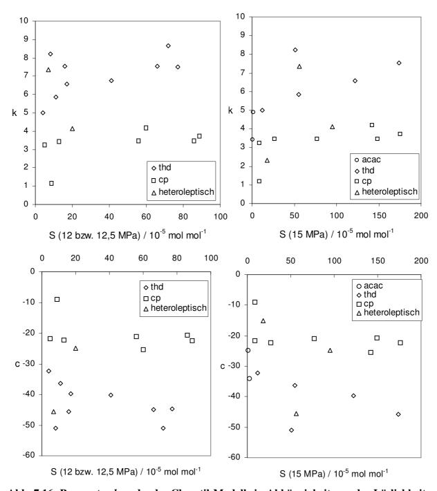
Abb. 7.16: Parameter k und c des Chrastil-Modells in Abhängigkeit von der Löslichkeit der Verbindungen in  $CO_2$  bei 60 °C; links: 12-12,5 MPa; rechts: 15 MPa.
