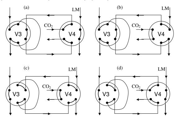
Abb. 5.4: Veranschaulichung der verschiedenen möglichen Ventilstellungen der 2-Wege-Ventile V3 und V4. (a) Probenschleife an den Sättigungskreislauf gekoppelt und Spülsystem mit  $CO_2$  durchströmt; (b) Probenschleife an den Sättigungskreislauf gekoppelt und Spülsystem mit Lösungsmittel durchströmt; (c) Probenschleife ans Spülsystem gekoppelt und mit Lösungsmittel durchströmt; (d) Probenschleife ans Spülsystem gekoppelt und mit  $CO_2$  durchströmt.
