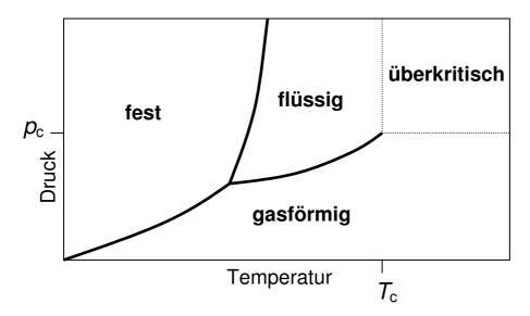
Abb. 3.4: Schematisches Phasendiagramm eines reinen Stoffes.
