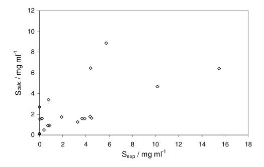
Abb. 7.23: Vergleich der experimentell ermittelten Löslichkeit  $S_{exp}$  und der nach der Korrelation mit dem Chrastil-Modell berechneten Löslichkeit  $S_{calc}$  für die untersuchten Verbindungen in  ${\rm CO_2}$  bei 60 °C und 15 MPa.
