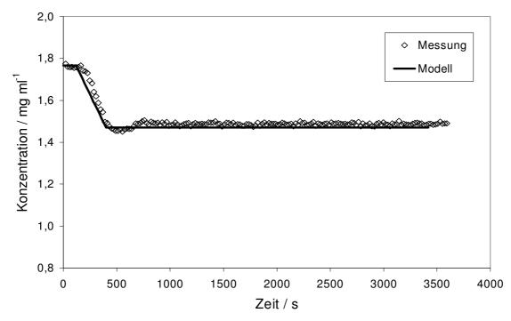
Abb. 6.4: Verlauf der Konzentrationsabnahme von  $Pt(cod)(me)_2$  in  $CO_2$  durch Volumenvergrößerung der Apparatur nach Umschalten auf die Beladungszelle ohne Trägermaterial am Beispiel eines Versuchs mit 30 mg  $Pt(cod)(me)_2$  bei 60 °C und 15 MPa.
