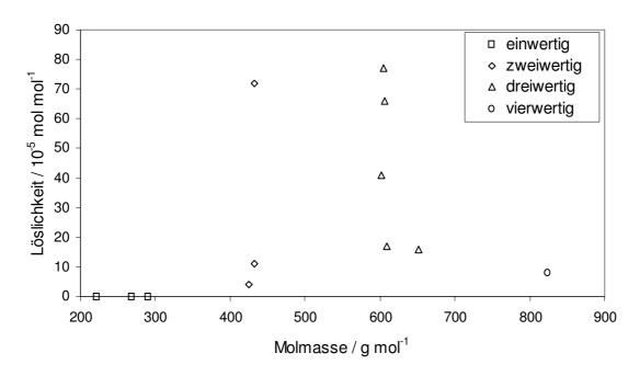
Abb. 7.9: Korrelation der Löslichkeit S von Tetramethylheptandionaten in überkritischem  $CO_2$  bei  $60\,^{\circ}C$  und 12 bzw. 12,5 MPa mit der molekularen Masse.
