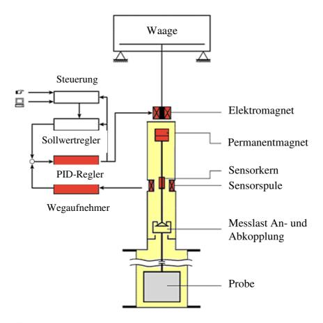
Abb. 6.1: Schematische Zeichnung der Magnetschwebewaage (Rubotherm 2004).
