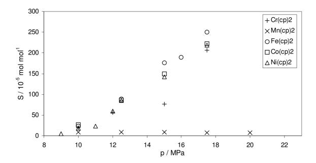
Abb. 7.12: Löslichkeit S von Cyclopentadienylen von Metallen der 4. Periode des Periodensystems der Elemente in überkritischem  $CO_2$  bei  $60\,^{\circ}C$ .
