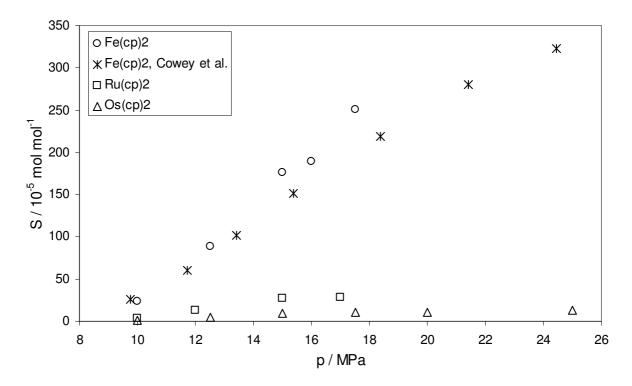
Abb. 7.11: Löslichkeit S von Cyclopentadienylen von Metallen der 8. Gruppe des Periodensystems der Elemente in überkritischem  $CO_2$  bei 60 °C; Werte von Cowey et al. aus Cowey 1995.
