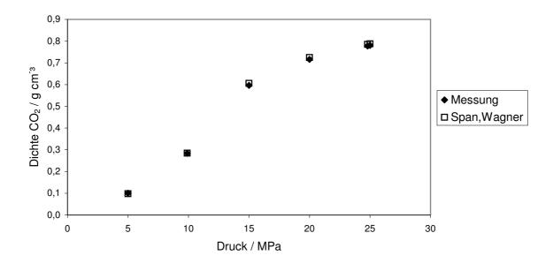
Abb. C.1: Dichte von CO<sub>2</sub> bei 60 °C, durch Messung ermittelt sowie aus einer Zustandsgleichung berechnet (Span, Wagner: Span 1996).
