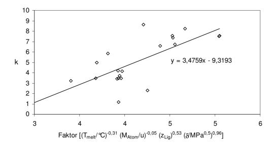
Abb. 7.22: Korrelation des Parameters k des Chrastil-Modells mit dem für die Liganden berechneten Faktor  $[(T_{\text{melt}}/^{\circ}\text{C})^{-0,31} (M_{\text{Atom}}/\text{u})^{-0,05} (z_{\text{Lig}})^{0,53} (\delta \text{MPa}^{0,5})^{0,96}]$ .
