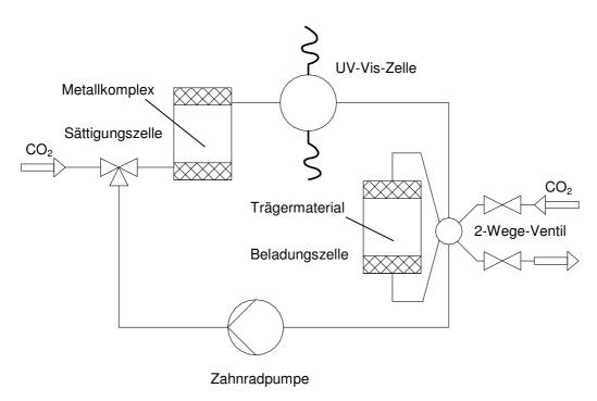
Abb. 6.2: Schematische Zeichnung der Apparatur mit Kreislaufführung der überkritischen Lösung zur Messung der Beladungskinetik.
