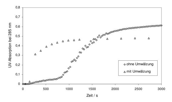
Abb. 8.13: Konzentrationsverlauf in Abhängigkeit der Zeit dargestellt als UV-Absorption bei 285 nm für die Auflösung von 40 mg  $Pt(cod)(me)_2$  in  $CO_2$  bei 60 °C und 15 MPa mit und ohne Umwälzung des Fluids.
