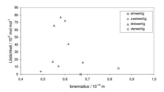
Abb. 7.10: Korrelation der Löslichkeit S von Tetramethylheptandionaten in überkritischem  $\mathrm{CO}_2$  bei 60 °C und 12 bzw. 12,5 MPa mit dem abgeschätzten Ionenradius des Zentralatoms.
