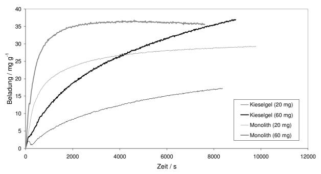
Abb. 8.5: Zeitlicher Verlauf der Beladung von monolithischem Trägermaterial sowie von Kieselgeltabletten mit  $Pt(cod)(me)_2$  in  $CO_2$  für Einwaagen an  $Pt(cod)(me)_2$  von 20 und 60 mg bei 60 °C und 15 MPa.
