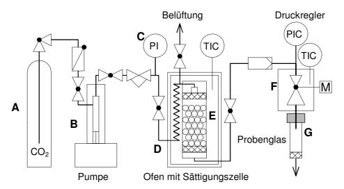
Abb. 5.1: Apparatur zur experimentellen Bestimmung der Löslichkeit von Feststoffen in überkritischem CO<sub>2</sub> mittels einer dynamisch-gravimetrischen Methode.
