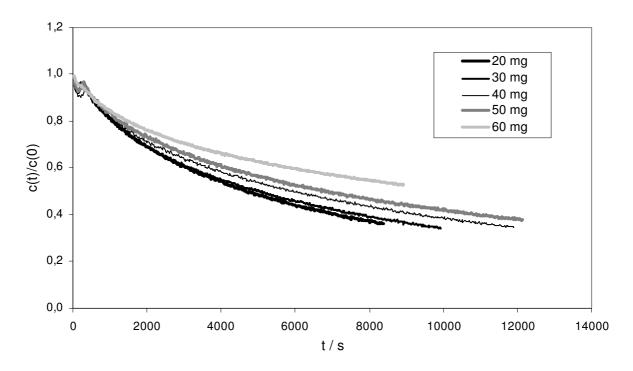
Abb. 8.8: Zeitlicher Verlauf der relativen Konzentration an Pt(cod)(me)<sub>2</sub> in CO<sub>2</sub> für Kieselgel mit verschiedenen Anfangskonzentrationen bei 60 °C und 15 MPa.
