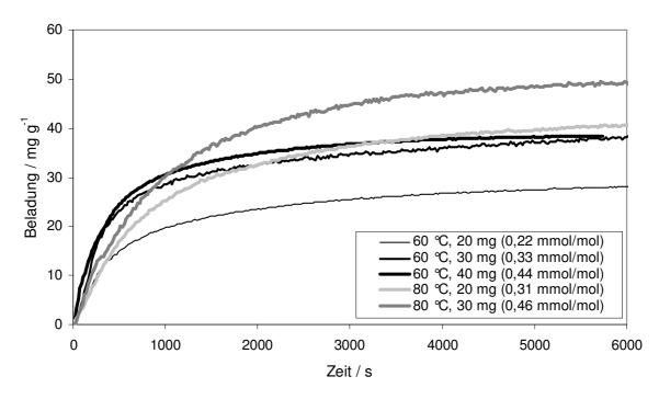
Abb. 8.10: Zeitlicher Verlauf der Beladung von monolithischem Trägermaterial mit  $Pt(cod)(me)_2$  in  $CO_2$  bei den Temperaturen 60 und 80 °C bei 15 MPa; angegeben sind die absoluten Mengen an  $Pt(cod)(me)_2$  sowie in Klammern die entsprechenden Stoffmengenverhältnisse von  $Pt(cod)(me)_2$  zu  $CO_2$ .
