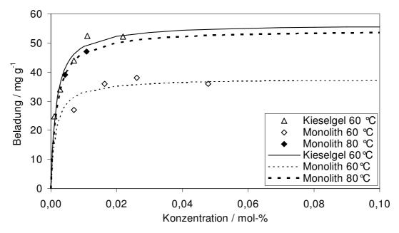
Abb. 8.12: Beladungsisothermen von monolithischem Trägermaterial und Kieselgeltabletten für die Beladung mit  $Pt(cod)(me)_2$  in  $CO_2$  bei 60 und 80 °C und 15 MPa und Anpassung der Daten an das Modell nach Langmuir.
