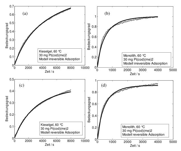
Abb. 8.14: Verlauf des Bedeckungsgrads in Abhängigkeit der Zeit für gemessene Werte (grau) und aus den Modellen für irreversible und reversible Adsorption durch Anpassung berechnete Werte (schwarz). Versuchsparameter: 30 mg Pt(cod)(me)<sub>2</sub> in CO<sub>2</sub>, 60 °C, 15 MPa. (a) Kieselgeltabletten, irreversibles Modell; (b) Monolith, irreversibles Modell; (c) Kieselgeltabletten, reversibles Modell; (d) Monolith, reversibles Modell.
