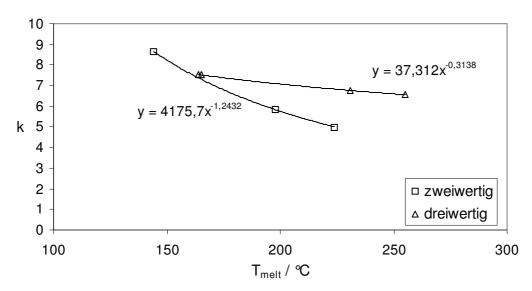
Abb. 7.18: Korrelation des Parameters k des Chrastil-Modells mit der Schmelztemperatur  $T_{\rm melt}$  der zweiwertigen und dreiwertigen thd-Verbindungen der 4. Periode im Periodensystem.
