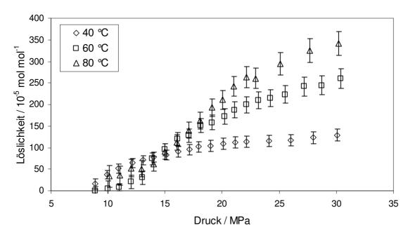
Abb. 7.1: Löslichkeit von Pt(cod)(me)<sub>2</sub> in CO<sub>2</sub> bei 40, 60 und 80 °C in Abhängigkeit des Drucks.
