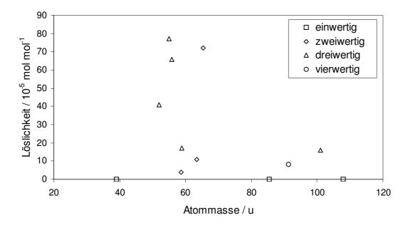
Abb. 7.8: Korrelation der Löslichkeit S von Tetramethylheptandionaten in überkritischem  $CO_2$  bei 60 °C und 12 bzw. 12,5 MPa mit der Masse des Zentralatoms.
