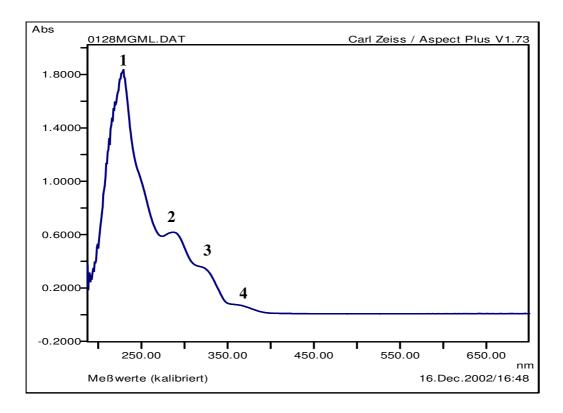
Abb. 5.5: UV/Vis-Spektrum für  $Pt(cod)(me)_2$  in n-Hexan bei einer Konzentration von 0,128 mg ml<sup>-1</sup>. Die erkennbaren Peaks liegen bei den Wellenlängen 230 nm (1), 288 nm (2), 320 nm (3) und 360 nm (4).
