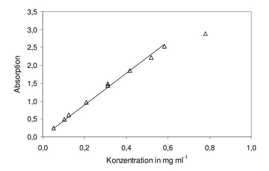
Abb. 5.6: Kalibrierkurve für die UV/Vis-Spektroskopie von  $Pt(cod)(me)_2$  in n-Hexan. Es ergibt sich für Konzentrationen bis maximal 0,6 mg ml<sup>-1</sup> eine Gerade nach Lambert-Beer. Gleichung der Anpassungsgeraden: y = 4,4264 x.
