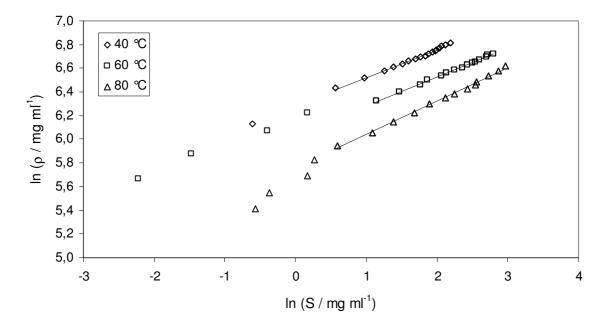
Abb. 7.14: Doppeltlogarithmische Auftragung der Fluiddichte  $\rho$  gegen die Löslichkeit S von Pt(cod)(me)<sub>2</sub> in überkritischem CO<sub>2</sub>; für die Näherungsgeraden wurden nur die Werte ln S > 0.5 verwendet.
