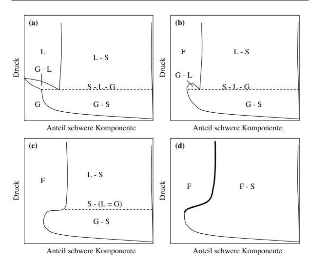
Abb. 3.6: Schnitte konstanter Temperatur für ein schematisches Phasendiagramm eines Zweistoffsystems mit einer festen Komponente. (a)  $T < T_{C1}$ ; (b)  $T_{C1} < T < T_{LCEP}$ ; (c)  $T = T_{LCEP}$ ; (d)  $T > T_{LCEP}$ . Die dick markierte Linie stellt den Bereich dar, der in der Regel bei Löslichkeitsmessungen erhalten wird.
