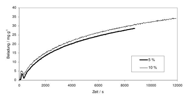
Abb. 8.3: Zeitlicher Verlauf der Beladung von Kieselgeltabletten mit 40 mg  $Pt(cod)(me)_2$  in  $CO_2$  bei 60 °C und 15 MPa für Einstellungen der Zahnradpumpe von 5 % und 10 % der maximalen Drehzahl (5000 min<sup>-1</sup>).
