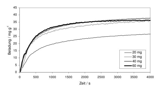
Abb. 8.7: Zeitlicher Verlauf der Beladung von monolithischem Trägermaterial mit Pt(cod)(me)<sub>2</sub> in CO<sub>2</sub> für verschiedene Mengen Pt(cod)(me)<sub>2</sub> bei 60 °C und 15 MPa.
