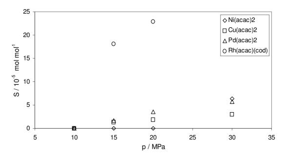
Abb. 7.5: Löslichkeit S verschiedener Verbindungen mit dem Liganden Acetylacetonat (acac) in überkritischem CO<sub>2</sub> bei 60 °C.
