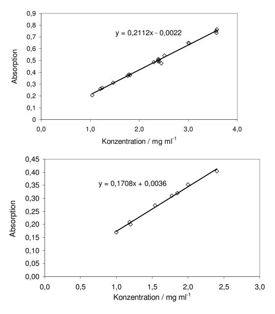
Abb. 6.3: Kalibriergeraden für die online-UV/Vis-Spektroskopie von  $Pt(cod)(me)_2$  in  $CO_2$  bei 15 MPa; UV/Vis-Absorption bei 285 nm in Abhängigkeit der Konzentration. Oben: 60 °C; unten: 80 °C.
