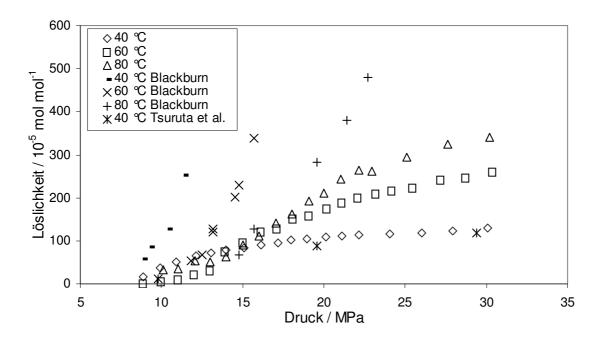
Abb. 7.2: Löslichkeit von  $Pt(cod)(me)_2$  in  $CO_2$  bei 40, 60 und 80 °C in Abhängigkeit des Drucks. Vergleich mit Literaturdaten: Blackburn (Blackburn 2001b), Tsuruta et al. (Tsuruta 2003).
