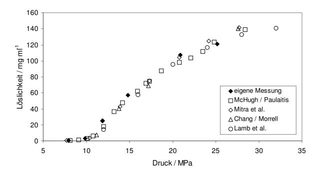
Abb. 5.8: Löslichkeit von Naphthalin in CO<sub>2</sub> bei 55 °C in Abhängigkeit des Drucks. Vergleich von Messergebnissen der Apparatur mit Kreislaufführung mit Literaturdaten (McHugh / Paulaitis (McHugh 1980), Mitra et al. (Mitra 1988), Chang / Morrell (Chang 1985), Lamb et al. (Lamb 1986)).
