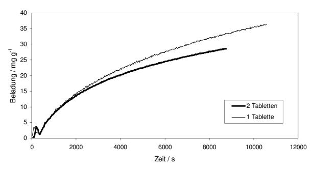
Abb. 8.4: Zeitlicher Verlauf der Beladung von Kieselgeltabletten mit 40 mg Pt(cod)(me)<sub>2</sub> in CO<sub>2</sub> bei 60 °C und 15 MPa für die Vorlage von einer sowie zwei Tabletten.
