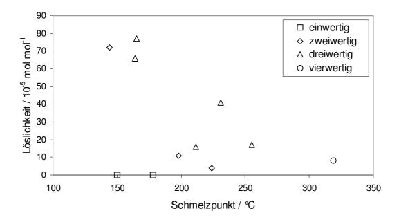
Abb. 7.7: Korrelation der Löslichkeit S von Tetramethylheptandionaten in überkritischem  $CO_2$  bei  $60\,^{\circ}C$  und 12 bzw. 12,5 MPa mit der Schmelztemperatur.
