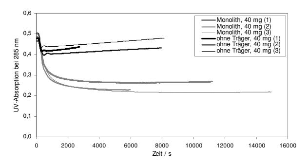
Abb. 8.1: Zeitlicher Verlauf der Abnahme der Pt(cod)(me)<sub>2</sub>-Konzentration, dargestellt als UV-Absorption bei 285 nm, in CO<sub>2</sub> bei 60 °C und 15 MPa für Beladungsversuche mit monolithischem Trägermaterial sowie Referenzversuche ohne Trägermaterial bei einer Einwaage an Pt(cod)(me)<sub>2</sub> von 40 mg.
