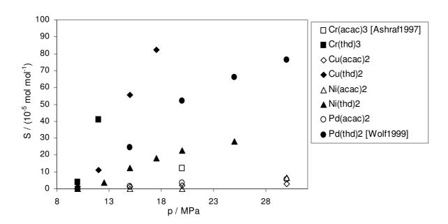
Abb. 7.4: Löslichkeit S verschiedener Acetylacetonate (acac) und Tetramethylheptandionate (thd) in überkritischem  $CO_2$  bei 60 °C. Daten für  $Cr(acac)_3$  aus Ashraf 1997, für  $Pd(thd)_2$  aus Wolf 1999.
