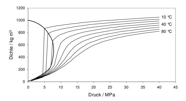
Abb. 3.5: Dichte von CO<sub>2</sub> in Abhängigkeit von Druck und Temperatur in der Nähe des kritischen Punkts. Die Phasengrenzlinie ist als dickere Linie eingezeichnet. Daten aus Span 1996.
