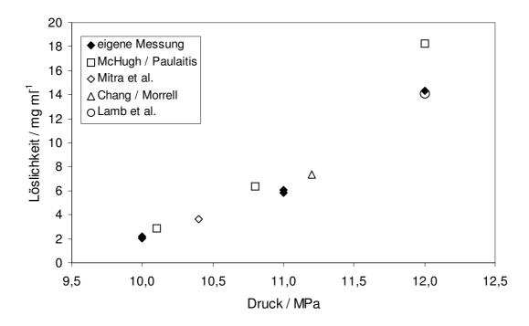
Abb. 5.7: Löslichkeit von Naphthalin in  $CO_2$  bei 55 °C in Abhängigkeit des Drucks. Vergleich von Messergebnissen der dynamisch-gravimetrischen Apparatur mit Literaturdaten (McHugh / Paulaitis (McHugh 1980), Mitra et al. (Mitra 1988), Chang / Morrell (Chang 1985), Lamb et al. (Lamb 1986)).
