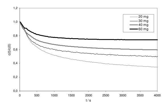
Abb. 8.9: Zeitlicher Verlauf der relativen Konzentration an  $Pt(cod)(me)_2$  in  $CO_2$  für monolithisches Trägermaterial mit verschiedenen Anfangskonzentrationen bei 60 °C und 15 MPa.
