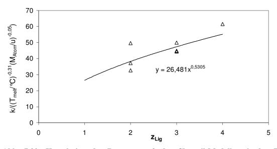
Abb. 7.20: Korrelation des Parameters k des Chrastil-Modells mit der Zahl der Liganden  $z_{\text{Lig}}$  der thd-Verbindungen.
