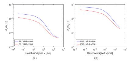
**Abbildung 7.14:** Verhältnis  $A_c/A_0$  von (a) Probekörper 8 (Schleifpapier 40) und (b) Probekörper 15 (Gestockt 4) in Abhängigkeit der Geschwindigkeit
