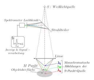
Abbildung 6.6: Schematische Darstellung des chromatisch-konfokalen Messprinzips nach [81]
