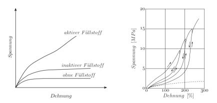
Abbildung 3.7: Schematische Darstellung des Einflusses verschiedener Füllstoffe auf das Spannungs-Dehnungs-Verhalten von Elastomeren nach [70] (links) und Spannungserweichung eines gefüllten Elastomers mit 100 phr Kautschuk und 60 phr N 330 nach [89] (rechts)
