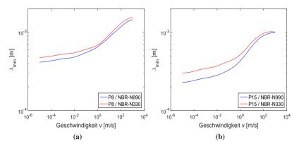
**Abbildung 7.15:** Minimale Länge  $\lambda_{min}$  von (a) Probekörper 8 (Schleifpapier 40) und (b) Probekörper 15 (Gestockt 4) in Abhängigkeit von der Geschwindigkeit
