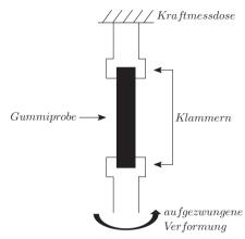
**(b)** Schematische Darstellung des Messprinzips bei der DMA-Messung
