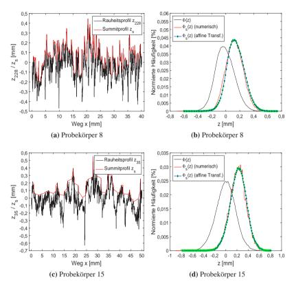
**Abbildung A.3:** Zufällig gewählte Profilschnitte und ermittelte Summitprofile (linke Darstellungen) und mittlere Höhenverteilungen  $\phi(z)$ , Summitverteilungen  $\phi_s(z)$  und affine Transformationen (rechte Darstellungen) der beiden Probekörper 8 (Schleifpapier 40) und Probekörper 15 (Gestockt 4)
