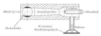
**Abbildung 2.2:** Schematische Darstellung eines Luftstromgreifers nach [35]
