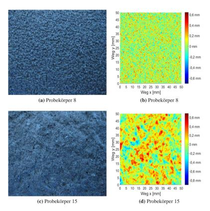
Abbildung A.1: Replikate (linke Darstellungen) und gemessene Oberflächenprofile (rechte Darstellungen) der beiden Probekörper 8 (Schleifpapier 40) und Probekörper 15 (Gestockt 4)
