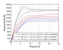
Abbildung F.1: Kraftkurven eines mit einem halbaktiven Ruß (N 550) gefüllten NBR (RE-1.2, Probekörper 8)
