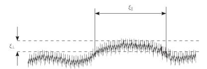
**Abbildung 5.9:** Schematische Darstellung der Korrelationslängen  $\xi_{\parallel}$  und  $\xi_{\perp}$  eines zufälligen Oberflächenprofils nach [32]
