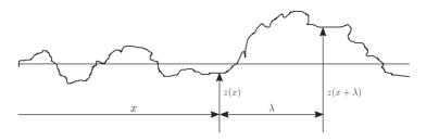
Abbildung 5.8: Profilwerte für die Höhendifferenzkorrelationsfunktion nach [96]
