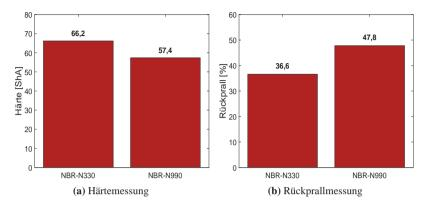
Abbildung B.3: Messung der Härte und der Rückprallelastizität eines mit einem aktiven (N 330) und passiven Ruß (N 990) gefüllten NBR (DIK-Mischungen)
