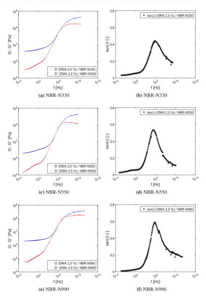
**Abbildung B.2:** Masterkurven des Speichermoduls (G'), Verlustmoduls (G'') und des Verlustangens  $(tan(\delta))$  eines mit Ruß gefüllten NBR  $(\varepsilon=2,5\%)$
