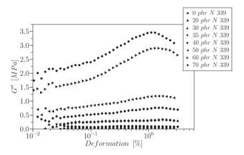
**Abbildung 3.14:** Dehnungsabhängige Messungen des Verlustmoduls (G'') von S-SBR-Proben gefüllt mit 0, 20, 30, 35, 40, 50, 60 und 70 phr N 339 ( $T=25\,^{\circ}C$ ,  $f=1\,Hz$ ) nach [23]
