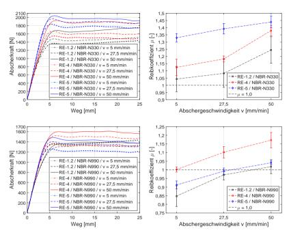
**Abbildung F.10:** Kraftkurven und Werte für den Reibkoeffizient  $\mu$  eines mit einem aktiven (N 330) und passiven (N 990) Ruß gefüllten NBR (RE-1.2, RE-4, RE-5,  $T=30\,^{\circ}C$ , Probekörper 15)
