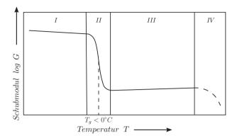
Abbildung 3.3: Schematische Darstellung der Temperaturabhängigkeit des Schubmoduls G von Elastomeren nach [89]
