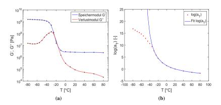
**Abbildung 6.13:** (a) Temperaturabhängigkeit des dynamischen Speicher- (G') und Verlustmoduls (G'') ( $\varepsilon=0,1$ %, f=1,0Hz, NBR-N990) (b) Verschiebungsfaktoren eines mit Ruß gefüllten NBR durch Erstellung von dynamischmechanischen Masterkurven  $(T_{ref}=20\,^{\circ}C, \varepsilon=0,1\,\%, \text{NBR-N990})$
