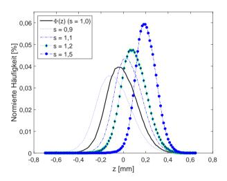
**Abbildung 5.4:** Originale Höhenverteilung  $\phi(z)$  für eine Schleifpapieroberfläche der Körnung 40 (schwarz) und verschiedene Summitverteilungen  $\phi_s(z)$  der größten Asperitäten für vier verschiedene Werte des affinen Parameters s
