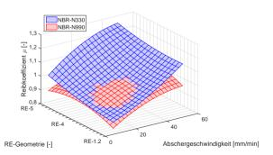
**Abbildung F.9:** Reibkoeffizient  $\mu$  eines mit einem aktiven (N 330) und passiven (N 990) Ruß gefüllten NBR (RE-1.2, RE-4, RE-5,  $T=30^{\circ}C$ , Probekörper 8)
