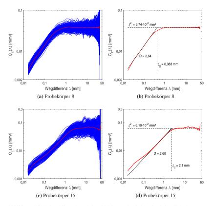
Abbildung A.2: Höhendifferenzkorrelationsfunktionen aller 250 Profilschnitte (linke Darstellungen) und mittlere HDK inklusive Oberflächendeskriptoren (rechte Darstellungen) der beiden Probekörper 8 (Schleifpapier 40) und Probekörper 15 (Gestockt 4)
