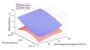
**Abbildung F.11:** Reibkoeffizient  $\mu$  eines mit einem aktiven (N 330) und passiven (N 990) Ruß gefüllten NBR (RE-1.2, RE-4, RE-5,  $T=30\,^{\circ}C$ , Probekörper 15)
