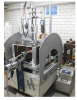
(a) Geschlossener Versuchsstand für Reibversuche
