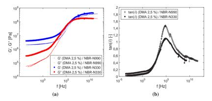
**Abbildung 7.10:** Masterkurven des (a) Speicher- (G') und Verlustmoduls (G'') (b) Verlust-tangens ( $tan(\delta)$ ) eines mit einem aktiven (N 330) und passiven (N 990) Ruß gefüllten NBR
