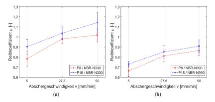
**Abbildung 7.9:** Reibkoeffizienten  $\mu$  auf den Probekörpern 8 (Schleifpapier 40) und 15 (Gestockt 4) für die (a) aktive Mischung und (b) passive Mischung
