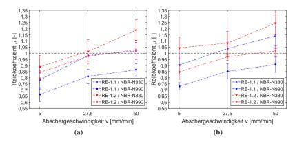
**Abbildung 7.19:** Die mit den Reibeinlagengeometrien RE-1.1 und RE-1.2 erzielten Reibkoeffizienten μ der aktiven und passiven Mischung für (a) Probekörper 8 (Schleifpapier 40) und (b) Probekörper 15 (Gestockt 4)
