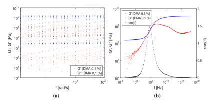
Abbildung 6.12: Frequenz- und temperaturabhängige dynamisch-mechanische Messungen an einem mit Ruß gefüllten NBR ( $\varepsilon$  = 0,1 %, NBR-N990) (a) frequenzabhängige Messwerte bei verschiedenen Temperaturen (b) resultierende Masterkurven der Moduln
