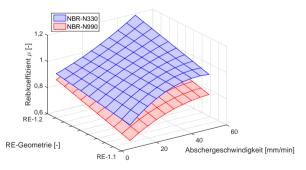
**Abbildung F.5:** Reibkoeffizient  $\mu$  eines mit einem aktiven (N 330) und passiven (N 990) Ruß gefüllten NBR (RE-1.1, RE-1.2, T = 30 °C, Probekörper 8)
