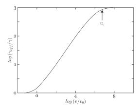
**Abbildung 5.13:** Die effektive Oberflächenenergie  $\gamma_{eff}$  in Abhängigkeit der Abziehgeschwindigkeit  $\nu$  nach [80]
