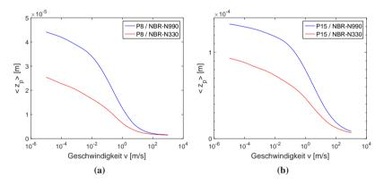
**Abbildung 7.13:** Mittlere Eindringtiefe  $< z_p >$  von (a) Probekörper 8 (Schleifpapier 40) und (b) Probekörper 15 (Gestockt 4)
