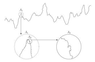
Abbildung 5.6: Schematische Darstellung eines selbstaffinen Rauheitsprofils nach [96].
