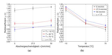
Abbildung 7.2: Reibkoeffizienten eines mit Ruß gefüllten NBR (N 550) in Abhängigkeit der Abschergeschwindigkeit und der Temperatur (AGW-Mischung, RE-1.2, 50 ShA, Probekörper 8)
