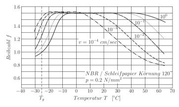
**Abbildung 4.7:** Temperaturabhängigkeit der Reibzahl f eines mit Ruß gefüllten NBR bei verschiedenen Gleitgeschwindigkeiten nach [87]
