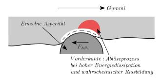
Abbildung 5.12: Schematische Darstellung eines lokalen Ablöseprozesses nach [57]
