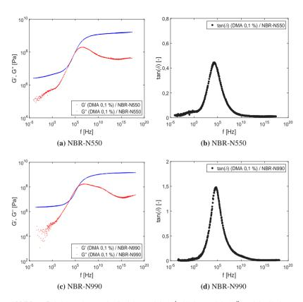
**Abbildung B.1:** Masterkurven des Speichermoduls (G'), Verlustmoduls (G'') und des Verlustangens ( $tan(\delta)$ ) eines mit Ruß gefüllten NBR ( $\varepsilon=0,1$ %)
