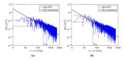
**Abbildung 7.8:** Spektrale Leistungsdichte S(n) für (a) Probekörper 8 (Schleifpapier 40) mit Topothesie  $k=5,2\cdot 10^{-12}\,m^3$  und (b) Probekörper 15 (Gestockt 4) mit Topothesie  $k=5,1\cdot 10^{-11}\,m^3$ ; die kleinste im Spektrum vorkommende Frequenz ergibt sich zu  $n_{min}=1/\xi_{\parallel}$
