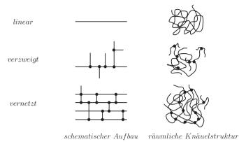
Abbildung 3.1: Lineare, verzweigte und vernetzte Makromolekülketten nach [98]
