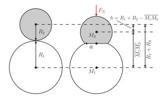
Abbildung 5.1: Kontakt zwischen zwei Kugeln mit den Radien R<sub>1</sub> und R<sub>2</sub> nach [57] und [11]
