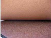
(b) Ablösen des ausgehärteten Negativabdruckes von der originalen Oberfläche
