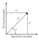
**Abbildung 3.6:** Vektordarstellung des komplexen Schubmoduls  $G^*$  nach [105]
