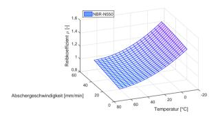
**Abbildung F.3:** Reibkoeffizient  $\mu$  eines mit einem Ruß (N 550) gefüllten NBR (RE-1.2, Probekörper 8)
