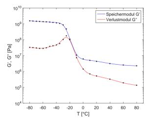
**Abbildung 7.3:** Temperaturabhängigkeit des dynamischen Speicher- (G') und Verlustmoduls (G'') (Prüfparameter:  $\varepsilon = 0.1\%$ , f = 1.0Hz, NBR-N550)
