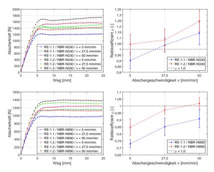
**Abbildung F.6:** Kraftkurven und Werte für den Reibkoeffizient  $\mu$  eines mit einem aktiven (N 330) und passiven (N 990) Ruß gefüllten NBR (RE-1.1, RE-1.2,  $T=30\,^{\circ}C$ , Probekörper 15)
