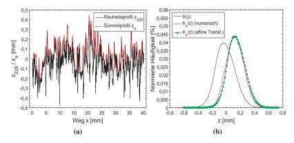
**Abbildung 7.6:** (a) Zufällig gewählter Profilschnitt (Profil-Nr. 228) und ermitteltes Summitprofil des Probekörpers 8 (Schleifpapier 40) und (b) mittlere Höhenverteilung  $\phi(z)$ , Summitverteilung  $\phi_s(z)$  und affine Transformation mit dem Parameter s
