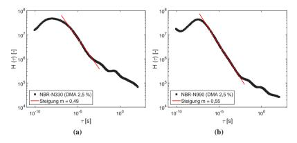
**Abbildung 7.11:** Relaxationszeitspektren (DMA 2,5 %) eines mit einem (a) aktiven (N 330) und (b) passiven (N 990) Ruß gefüllten NBR: die Fitkurven entsprechen  $H(\tau) = \tau^{-m}$
