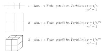
**Abbildung E.2:** Herleitung der fraktalen Dimension *D* nach [52]
