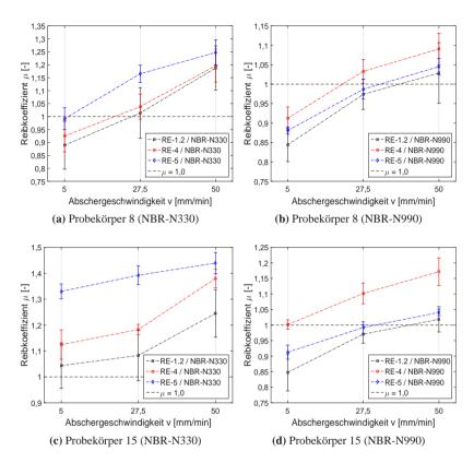
**Abbildung 7.20:** Die mit den Reibeinlagengeometrien RE-1.2, RE-4 und RE-5 erzielten Reibkoeffizienten  $\mu$  der aktiven und passiven Mischung für Probekörper 8 (Schleifpapier 40) und Probekörper 15 (Gestockt 4)
