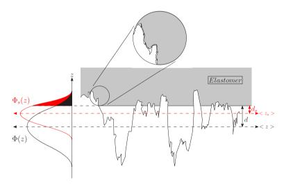
**Abbildung 5.5:** Oberflächenrauheitsprofil und eingedrücktes Elastomer inkl. Höhenverteilung  $\phi(z)$  u. Summitverteilung  $\phi_s(z)$  des Rauheitsprofils nach [92], [57], [11]
