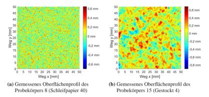
**Abbildung 6.7:** Oberflächenprofile unterschiedlicher Probekörper (Messfeld: 50 mm × 50 mm)
