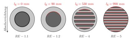
**Abbildung 7.17:** Reibeinlagengeometrien und effektive Kantenlängen  $l_K$
