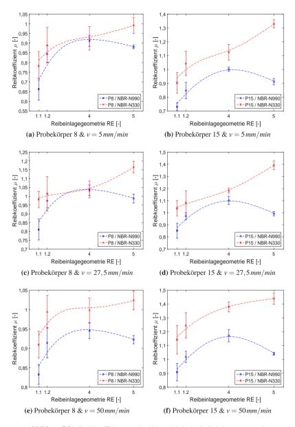
**Abbildung 7.21:** Reibkoeffizienten  $\mu$  in Abhängigkeit der Reibeinlagengeometrie
