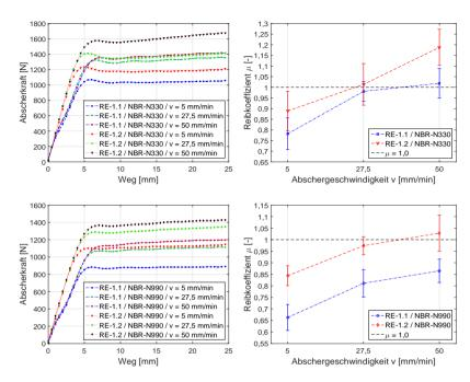
**Abbildung F.4:** Kraftkurven und Werte für den Reibkoeffizient  $\mu$  eines mit einem aktiven (N 330) und passiven (N 990) Ruß gefüllten NBR (RE-1.1, RE-1.2,  $T=30\,^{\circ}C$ , Probekörper 8)
