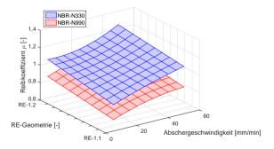
**Abbildung F.7:** Reibkoeffizient  $\mu$  eines mit einem aktiven (N 330) und passiven (N 990) Ruß gefüllten NBR (RE-1.1, RE-1.2,  $T=30\,^{\circ}C$ , Probekörper 15)
