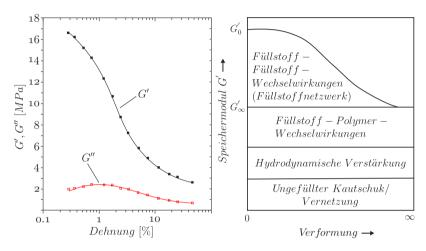
Abbildung 3.8: Speicher- und Verlustmodul in Abhängigkeit der Dehnung einer mit 80 phr Ruß gefüllten SBR-Probe nach [5] (links) und Deformationsabhängigkeit des Speichermoduls gefüllter Elastomere nach [99] (rechts)
