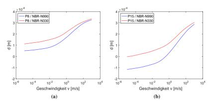
**Abbildung 7.12:** Höhe *d* zwischen dem Elastomer und der mittleren Rauheitshöhe von (a) Probekörper 8 (Schleifpapier 40) und (b) Probekörper 15 (Gestockt 4)
