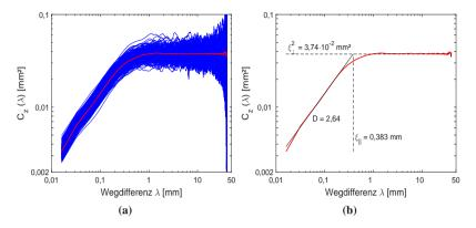
Abbildung 7.5: (a) Höhendifferenzkorrelationsfunktionen aller 250 Profilschnitte und (b) mittlere HDK inklusive Oberflächendeskriptoren des Probekörpers 8 (Schleifpapier 40)
