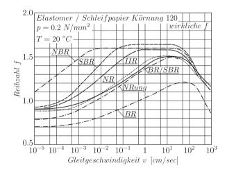
**Abbildung 4.8:** Geschwindigkeitsabhängigkeit der Reibzahl f verschiedener Elastomere nach [87]
