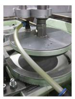
(b) Vakuumgreifer, Abspannelement und Probenschlitten
