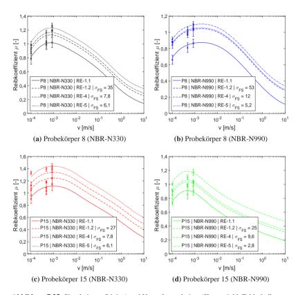
Abbildung 7.25: Simulations- (Linien) und Versuchsergebnisse (Kreuze inkl. Fehlerbalken der Standardabweichung) des Reibkoeffizienten als Summe der Hysterese-, Adhäsions- und Formschlussreibung (Reibeinlagengeometrie RE-1.2, RE-4 und RE-5)
