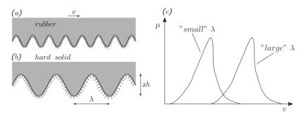
**Abbildung 4.9:** Gummireibung auf harter Oberfläche für zwei unterschiedliche Rauheiten (a) und (b). Die Beiträge zur Reibung aufgrund innerer Dämpfungseffekte sind bei beiden Rauheiten identisch, da das Verhältnis von Amplitude zu Wellenlänge gleich ist. Die geschwindigkeitsabhängigen  $\mu(\nu)$ -Kurven des Reibkoeffizienten für beide Rauheiten sind schematisch in (c) dargestellt (nach [77]).
