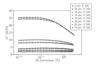
**Abbildung 3.13:** Dehnungsabhängige Messungen des Speichermoduls (G') von S-SBR-Proben gefüllt mit 0, 20, 30, 35, 40, 50, 60 und 70 phr N 339 ( $T=25\,^{\circ}C$ ,  $f=1\,Hz$ ) nach [23]
