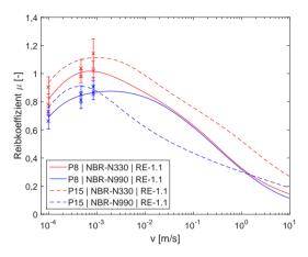
**Abbildung 7.23:** Simulations- (Linien) und Versuchsergebnisse (Kreuze inkl. Fehlerbalken der Standardabweichung) des Reibkoeffizienten als Summe der Hysterese- und Adhäsionsreibung (Reibeinlagengeometrie RE-1.1)
