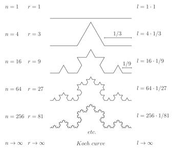
Abbildung E.1: Konstruktion der Koch-Kurve nach [52]
