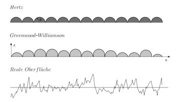
Abbildung 5.2: Schematische Darstellungen der Interpretationen einer rauen Oberfläche nach Hertz (oben) und nach Greenwood und Williamson (Mitte) sowie schematische Darstellung einer realen Oberfläche (unten) nach [79]
