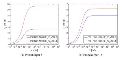
**Abbildung 7.24:** Scherspannung  $\tau_s$  der aktiven (NBR-N330) und passiven (NBR-N990) Mischung für (a) Probekörper 8 (Schleifpapier 40) und (b) Probekörper 15 (Gestockt 4)
