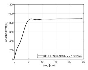
Abbildung 6.16: Reibkraftkurve eines mit einem passiven Ruß (N 990) gefüllten NBR bei einer Abschergeschwindigkeit von 5 mm/min (Probekörper 8)
