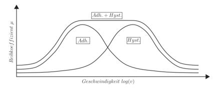
**Abbildung 7.22:** Schematische Darstellung des Gesamtreibkoeffizienten μ, bestehend aus den Einzelbeiträgen der Adhäsion und Hysterese in Abhängigkeit von der Geschwindigkeit
