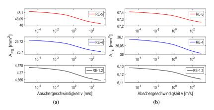
**Abbildung 7.18:** Formschlussflächen  $A_{FS}$  der aktiven Mischung für (a) Probekörper 8 (Schleifpapier 40) und (b) Probekörper 15 (Gestockt 4)
