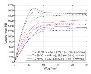
Abbildung 7.1: Reibkraftkurven eines mit Ruß gefüllten NBR (N 550) in Abhängigkeit der Temperatur und der Abschergeschwindigkeit (AGW-Mischung, RE-1.2, 50 ShA, Probekörper 8)
