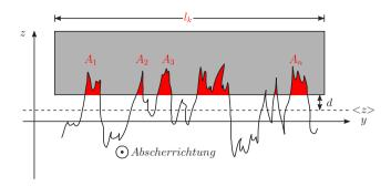
**Abbildung 5.15:** Schematische Darstellung der Formschlussflächen  $A_i$  eines Gummiprofils mit der Kantenlänge  $I_K$  beim Gleitvorgang in Abscherrichtung
