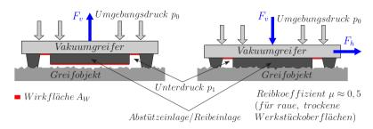
**Abbildung 2.5:** Schematische Darstellung des Wirkprinzips eines Vakuumgreifers und angegebener Wert für den Reibkoeffizienten μ für raue, trockene Werkstückoberflächen, wie z.B. Glas, Stein oder Kunststoff [38]
