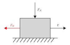
**Abbildung 4.1:** Schematische Darstellung des Reibprozesses nach [57]
