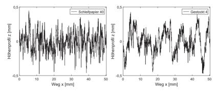
**Abbildung 7.4:** Einzelnes Höhenprofil z(x) der Probekörper 8 (Schleifpapier 40) und Probekörper 15 (Gestockt 4)
