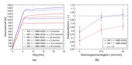
**Abbildung 7.16:** (a) Reibkraftkurven und (b) Werte für den Reibkoeffizienten μ eines mit einem aktiven (N 330) und passiven (N 990) Ruß gefüllten NBR in Abhängigkeit von der Abschergeschwindigkeit (RE-1.1, Probekörper 8)
