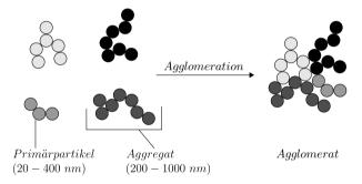
Abbildung 3.9: Schematische Darstellung des strukturellen Aufbaus von Rußagglomeraten nach [23]
