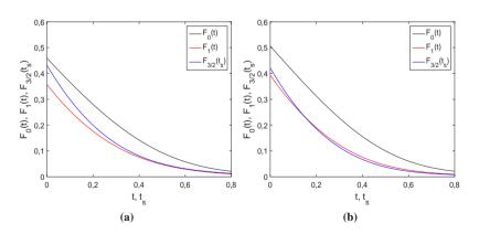
Abbildung 7.7: Greenwood-Williamson-Funktionen (a) des Probekörpers 8 (Schleifpapier 40) und (b) des Probekörpers 15 (Gestockt 4)
