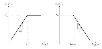
**Abbildung 5.10:** Schematische Darstellung der Höhendifferenzkorrelationsfunktion  $C_z(\lambda)$  (links) und der spektralen Leistungsdichte  $S(\omega)$  (rechts) einer selbstaffinen Oberfläche mit den entsprechenden Deskriptoren nach [57]
