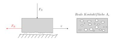
Abbildung 5.11: Schematische Darstellung der wahren Kontaktfläche nach [57]
