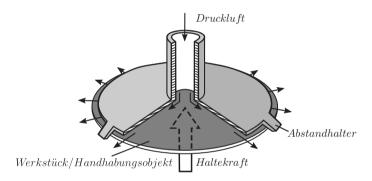
**Abbildung 2.4:** Beispiel eines Druckluftgreifers nach [35]
