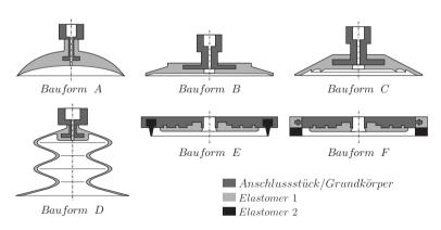
Abbildung 2.7: Bauformen von Vakuumgreifern [7]
