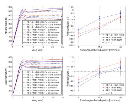
**Abbildung F.8:** Kraftkurven und Werte für den Reibkoeffizient  $\mu$  eines mit einem aktiven (N 330) und passiven (N 990) Ruß gefüllten NBR (RE-1.2, RE-4, RE-5,  $T=30\,^{\circ}C$ , Probekörper 8)
