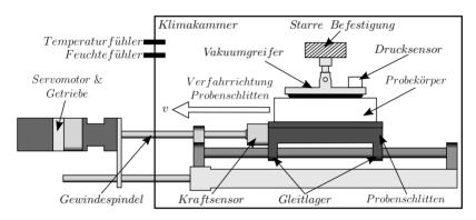
**Abbildung 6.15:** Schematische Darstellung eines Abscherversuches und Verfahrrichtung des Probenschlittens bei starrer Einbaulage des Vakuumgreifers
