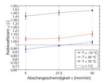
**Abbildung F.2:** Werte für den Reibkoeffizient  $\mu$  eines mit einem halbaktiven Ruß (N 550) gefüllten NBR (RE-1.2, Probekörper 8)
