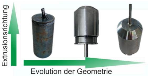
Abbildung 4.5: Veränderung der Kapselgeometrie zur Verbesserung der Ausbeute und Verkleinerung der Totzone.
