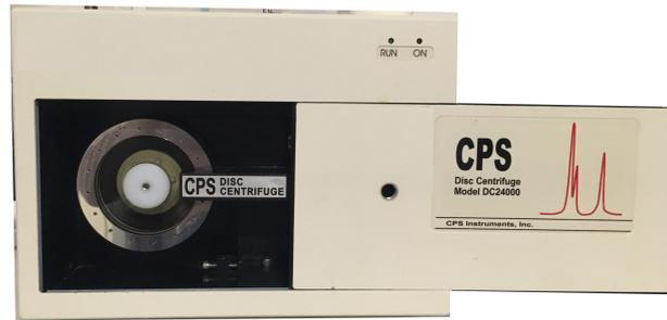
**Abbildung 3.1:** Totalansicht der CPS-Scheibenzentrifuge DC24000.
