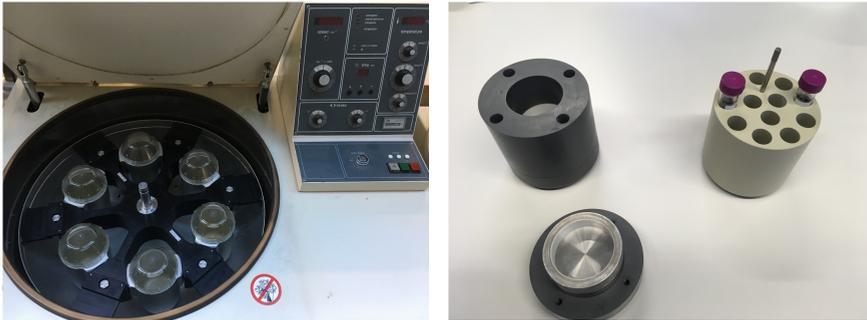
**Abbildung 3.3:** Links: Totalansicht der Hermle-Kühlzentrifuge. Rechts: Überblick der für die Messungen eingesetzten Bechersysteme.
